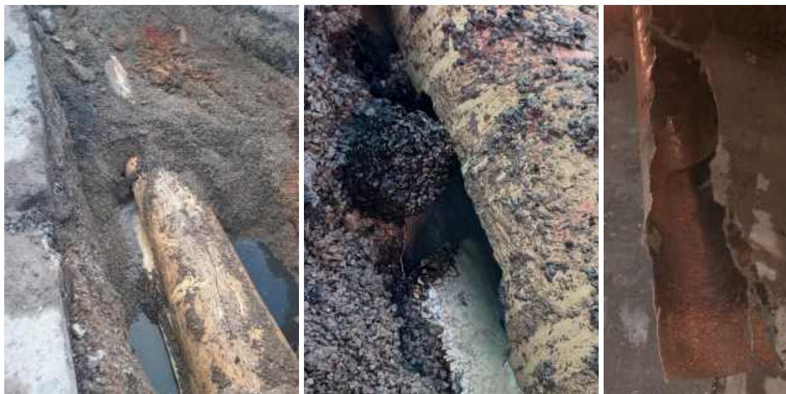
Mise en évidence du trou dans la canalisation - Canalisation corrodée par l'H 2 S
